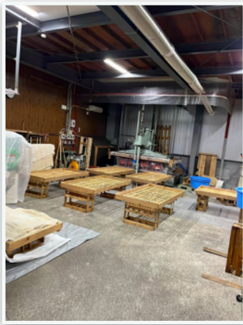
〈朝9時に開始する仕込みの様子：並んだ簀で蒸米を覚ましていく作業〉
