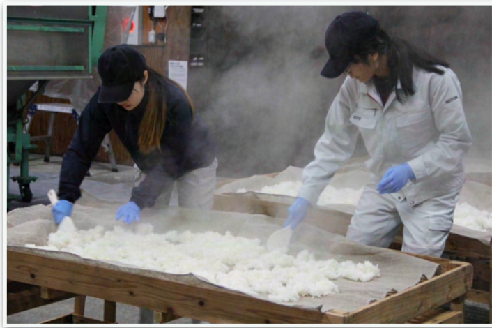
〈朝9時に開始する仕込みの様子：並んだ簀で蒸米を覚ましていく作業〉
